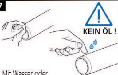
Mit Wasser oder Schmiermittel (siehe M5/2) anfeuchten
